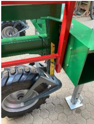
Skalen für Einstellungstiefen an Spurrad, Tastrad und Pflanzschar
