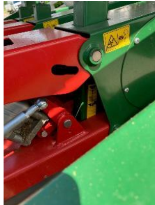
Skalen für Einstellungstiefen an Spurrad, Tastrad und Pflanzschar
