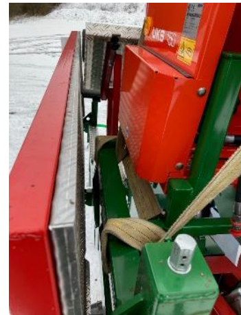
Anheben mit Schlingen um den Seitenrahmen
