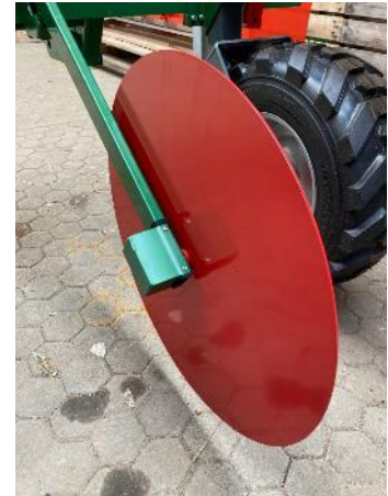
Schutzscheibe mit Sensor für Fahrgeschwindigkeit
