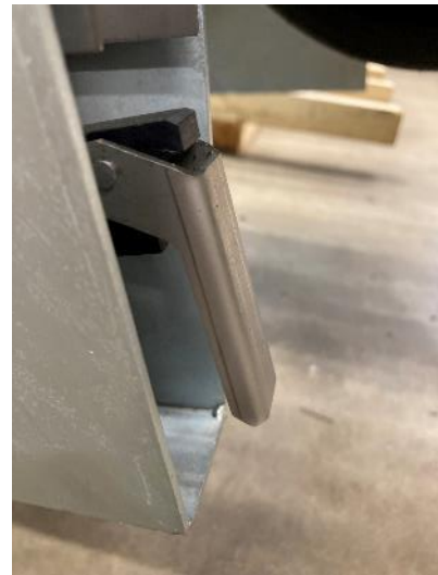
Die Schieberklappe – dahinter befindet sich eine Verstellerschraube
